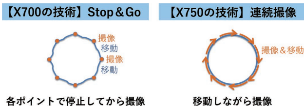
図 5 X700 の STOP&GO 方式と X750 の連続撮像
