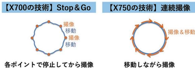
図5 X700のSTOP&GO方式とX750の連続撮像
