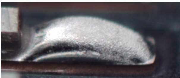
図3 不濡れはんだ形状 (外観)
