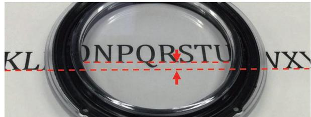
図 15 ボタン可動部の透明ポリカーボネート
