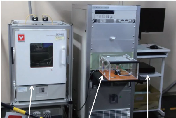
恒温槽 直流重畳試験器 自動測定用PC
