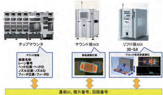
図7 検査情報と実装情報の紐付け
