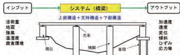
図2 インプットとアウトプットによる評価
