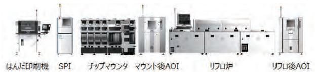
図3 電子部品基板の実装ライン
