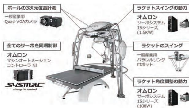
図1 卓球ロボットのシステム構成
