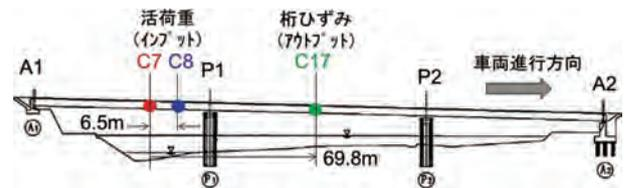
図22 ひずみセンサの設置位置
