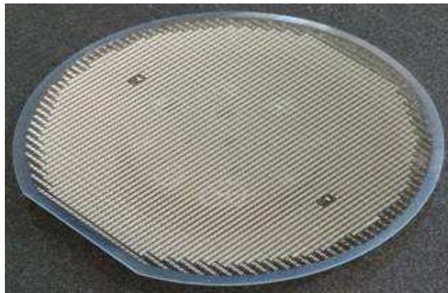
ウェハ上に成型された RF MEMSスイッチ
