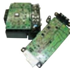
[電動パワーステアリングコントローラ]
