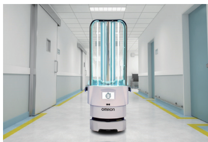
消毒作業時の感染症拡大防止につなげる 紫外線光照射器ロボット
