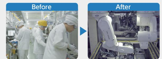
従来は10人がかりで行っていた、各装置への部品の設置と工程間移動を完全自働化した天井吊り下げ型のロボット
