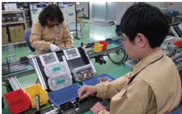
右手を使う作業員と左手を使う作業員が対になって作業を行うソケット製造ライン
