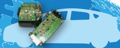
電動パワーステアリングコントローラー
