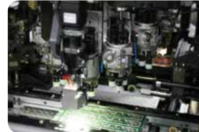
基板に部品を実装している様子
