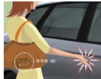
携帯機(鍵)を取り出すことなくドアハンドルにタッチ(もしくはドアスイッチ操作)するだけで、開錠し乗車できます。
