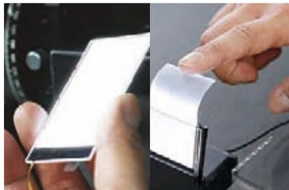
光源であるLEDとその光を均一に面発光させる導光板の接合部分に、微小なプリズムを放射状に形成する「ラジアルプリズム構造」というオムロンならではの特殊加工を施し、LEDの光の95%(従来は75%)を液晶画面まで導くことを可能にしました。また、試行錯誤の末に生み出した微細加工技術、微細複製技術によって、複雑なラジアルプリズム構造のシート型バックライトの量産に成功しました。フレキシブル性をも備えたバックライトは、新たな表示装置の提案にもつながると期待しています。
