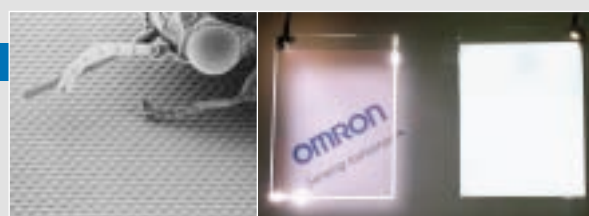
MLA技術 微細なレンズのパターンを作成する技術 左より、サブ側（フロントライト）メイン側（バックライト）
