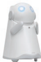
駅案内ロボット サイズ(幅178×奥行237×高さ301mm)
