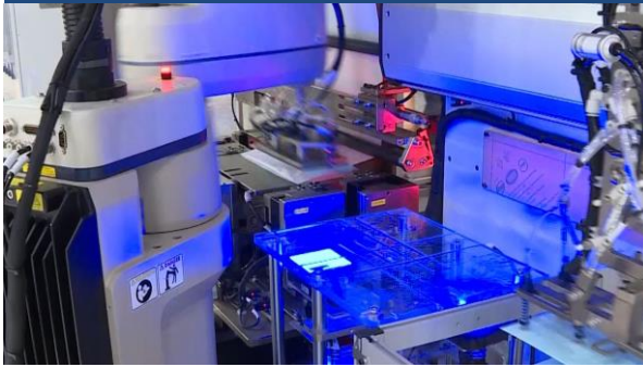
ロボットが供給した電極材をラミネートフィルムで包む工程 (中国のオートメーションセンタのデモ機)
